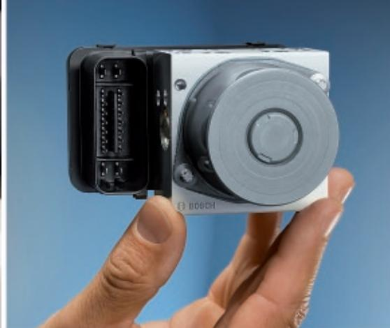
El SYM Maxsym 400 i ABS equipa la última generación Bosch ABS 9, un sistema un 50% más compacto que el precedente (su peso es de sólo 700 gr) y que además incorpora un nuevo sensor de presión adicional sensible incluso a gravilla o asfalto manchado. El nuevo módulo Bosch es capaz de regular en décimas de segundo la presión necesaria para garantizar la máxima seguridad en cada frenada.
