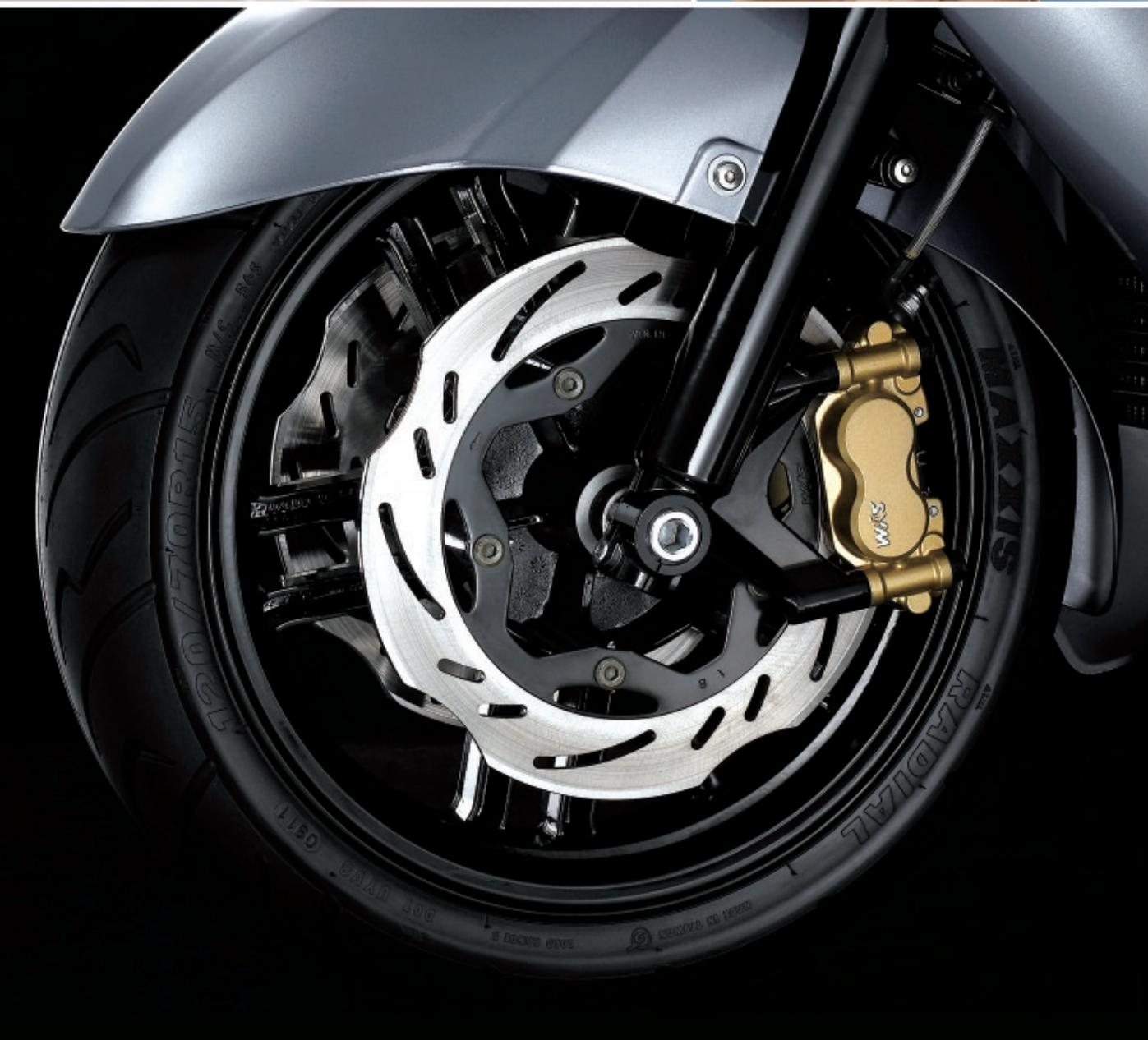
Para garantizar una conducción totalmente segura, el Maxsym cuenta con tres potentes frenos de disco “wave”, un sistema de frenada combinada que equilibra el reparto de la presión ejercida por el piloto entre el tren delantero y el trasero, y un práctico freno manual de estacionamiento.
